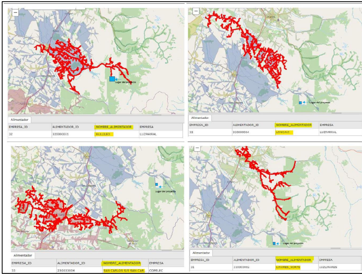
Figura N°8: Alternativa técnico-económica óptima que representa el Alimentador Bullileo en comparación con los otros alimentadores existentes en esta zona geográfica, cercana al Embalse Bullileo 83 .
