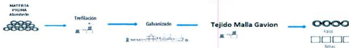
Figura No. 7 Fabricación de malla gavión
