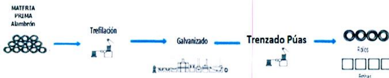
Figura No. 4 Fabricación de alambre de púas
