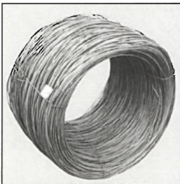
Son barras de acero con núcleo de sección circular, longitud continua y superficie lisa, obtenida por laminación en caliente de palanquillas. Este producto se destina a ser trefilado o transformado en frío. Más concretamente, también puede ser empleado para la fabricación de electrodos para soldadura, alambres finos, alambres con destino a grapas, puntillas, clavos, cables de bajas exigencias, alambres de resistencia media o elementos de fijación, entre otros.
