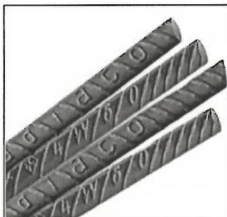
Las barras corrugadas son barras de acero con núcleo de sección circular y longitud continua (rectas) obtenidas por laminación en caliente en cuya superficie existen salientes denominadas corrugas.
